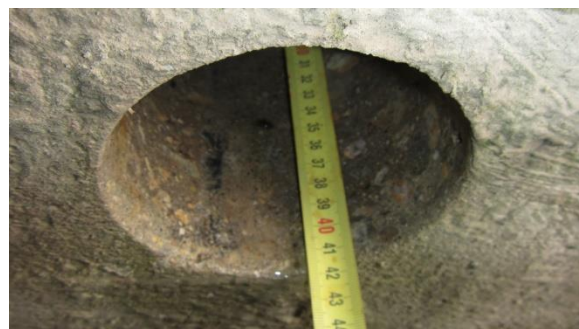
Foto 4.3.2 Foto měření hloubky provedeného návrtu po vyjmutí vzorků betonu ze sondy do dířku opěry OP2 (pravá opěra ve směru toku)
